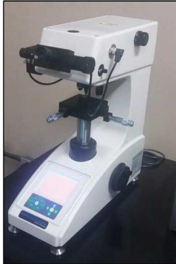
**Figura 27:** Micrôdurômetro da Wilson Instruments – Vicker/Knoop disponibilizado pelo CEFET/RJ.
