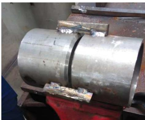
**Figura 19:** Preparação da Junta soldada
