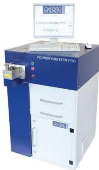
**Figura 24:** Espectrômetro de Emissão Óptica.
