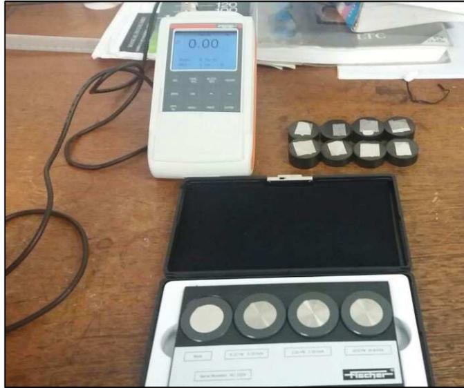
**Figura 25:** Ferritoscópio Helmut Fischer disponibilizado pela NUCLEP.
